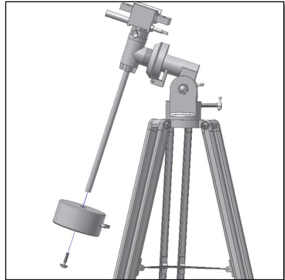
Abb. 5. Befestigen des Gegengewichts, Einschoben des Gegengewichts.
