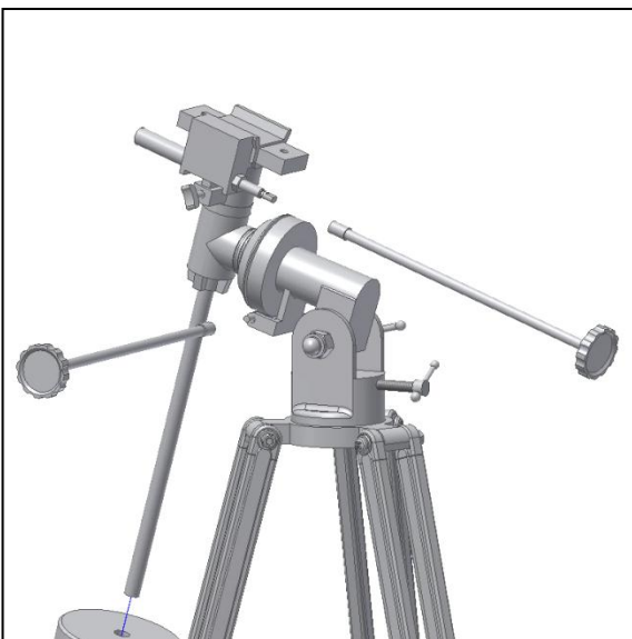
Abb. 6. Befestigen der Deklinations- und Rektaszensionsgriffe.
