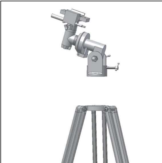
Abb. 4. Setzen Sie den Kopf der äquatorialen Montierung auf das Stativ.
